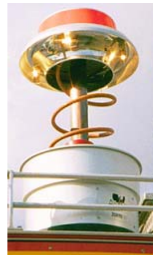
Bild 9 rechts: Lichtmast zum Teil ausgefahren
